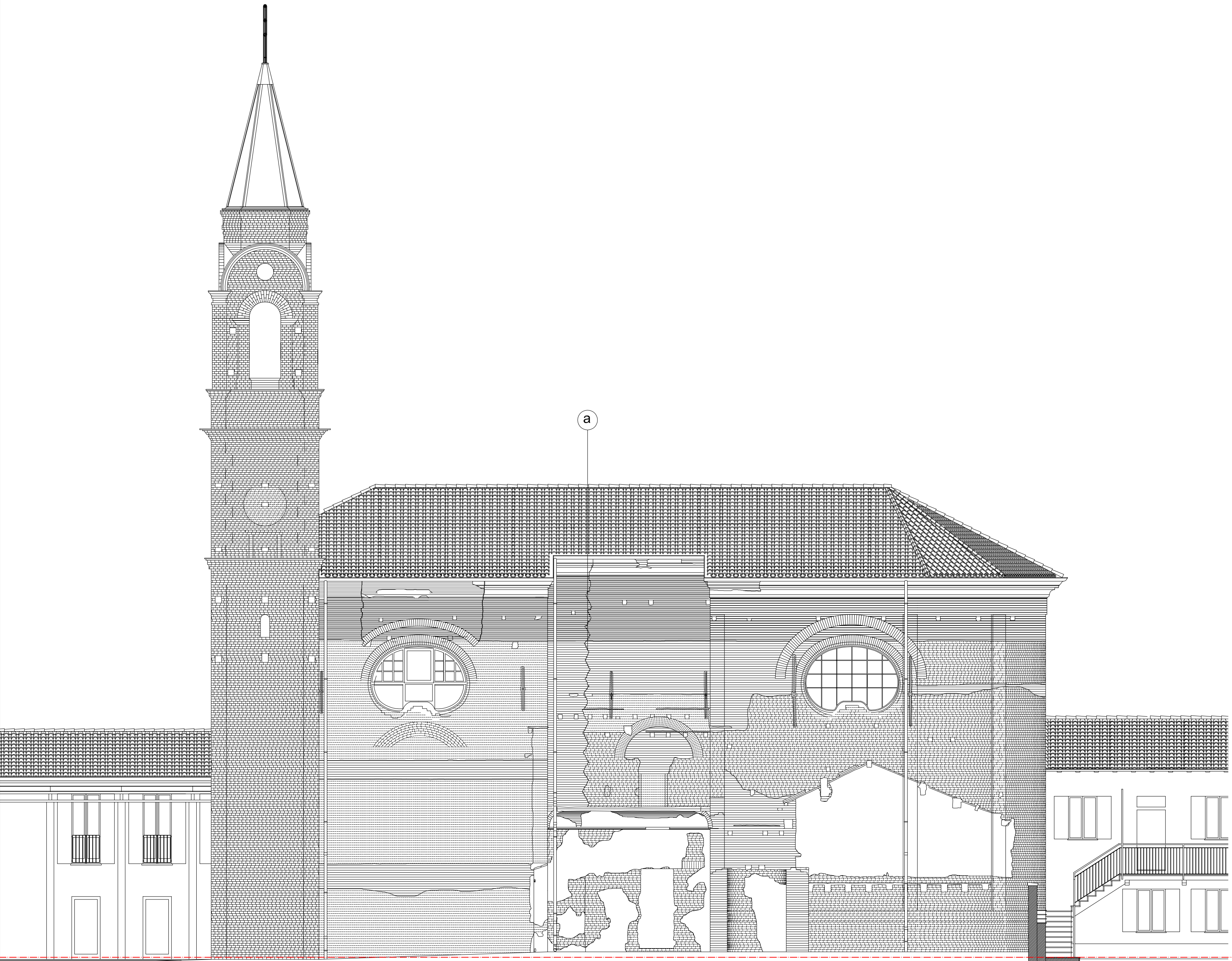
BB a ammorsatura continua fra partiti murari diversi
