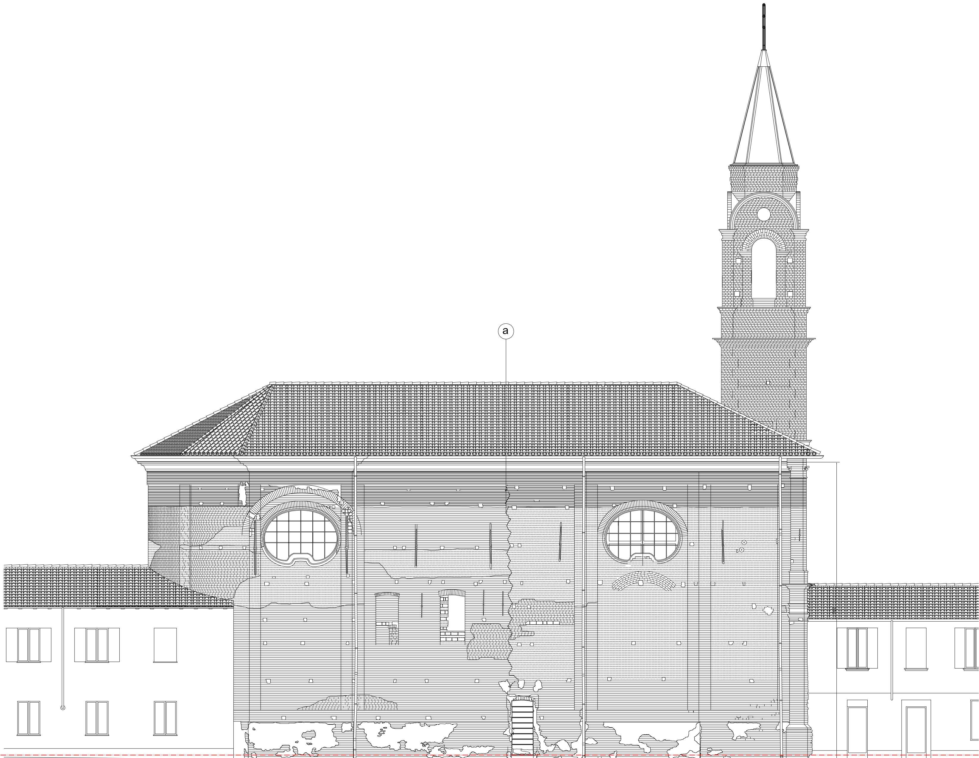
AA a ammorsatura continua fra partiti murari diversi
